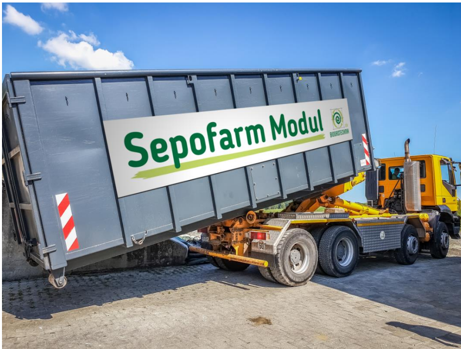
Abbildung 4: Speziell entwickelter Fest/Flüssig Container für den Transport
