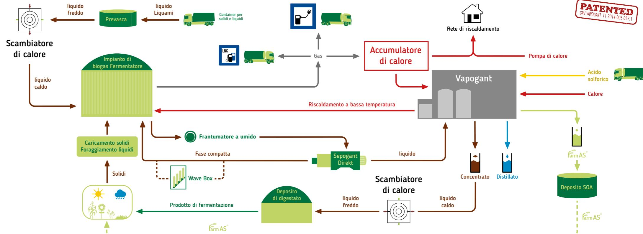
L'obiettivo di VapoCircle® è ottenere un circuito agricolo unico per la produzione di biogas e la nobilitazione di substrato con produzione propria di concime minerale per i nuovi impianti e il repowering. Ciò è possibile grazie a un impianto di cogenerazione flex o un impianto di cogenerazione + Bio-LNG & CO2.
