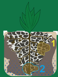
Strip Till 1) Düngerdepot 2) Wasserdepot Quelle: Volmer Engineering
