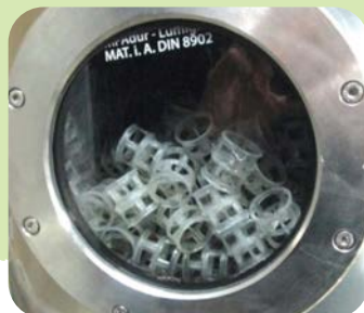
Füllkörper im Brüdenwäscher
