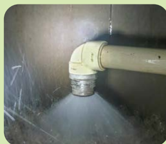
Buse dans l'évaporateur de vapeur
