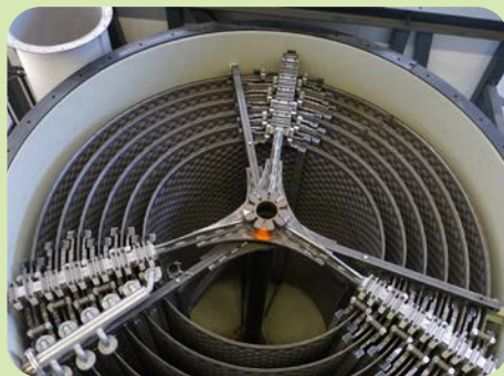
Brosses et plaques chauffantes dans l'évaporateur
